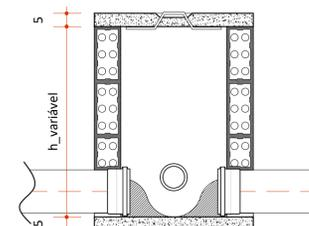
**CORTE GENÉRICO CAIXA DE ESGOTO**
