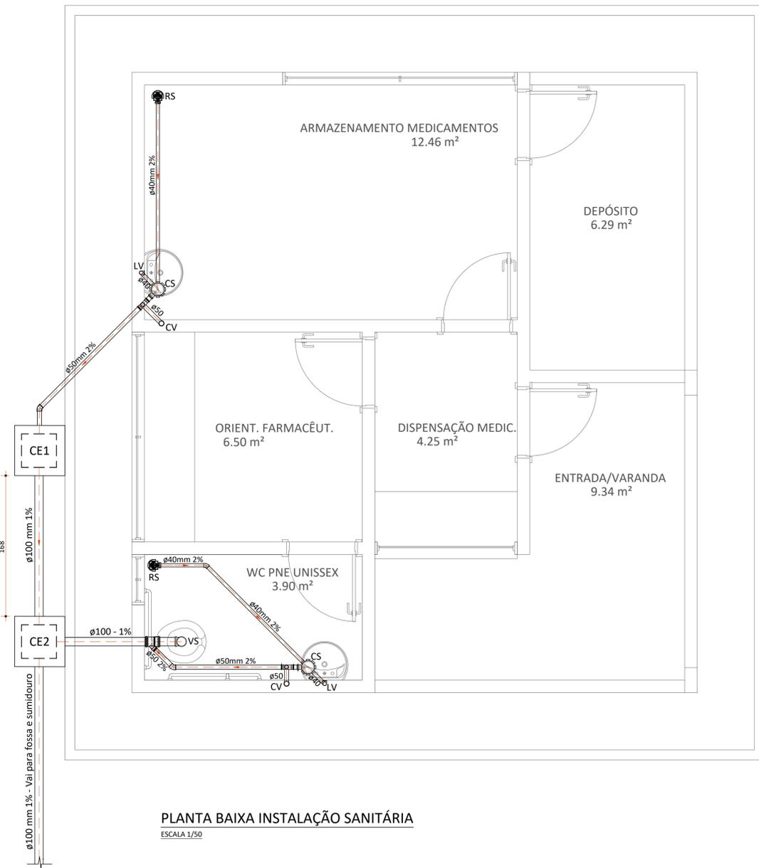
**PLANTA BAIXA INSTALAÇÃO SANITÁRIA**
