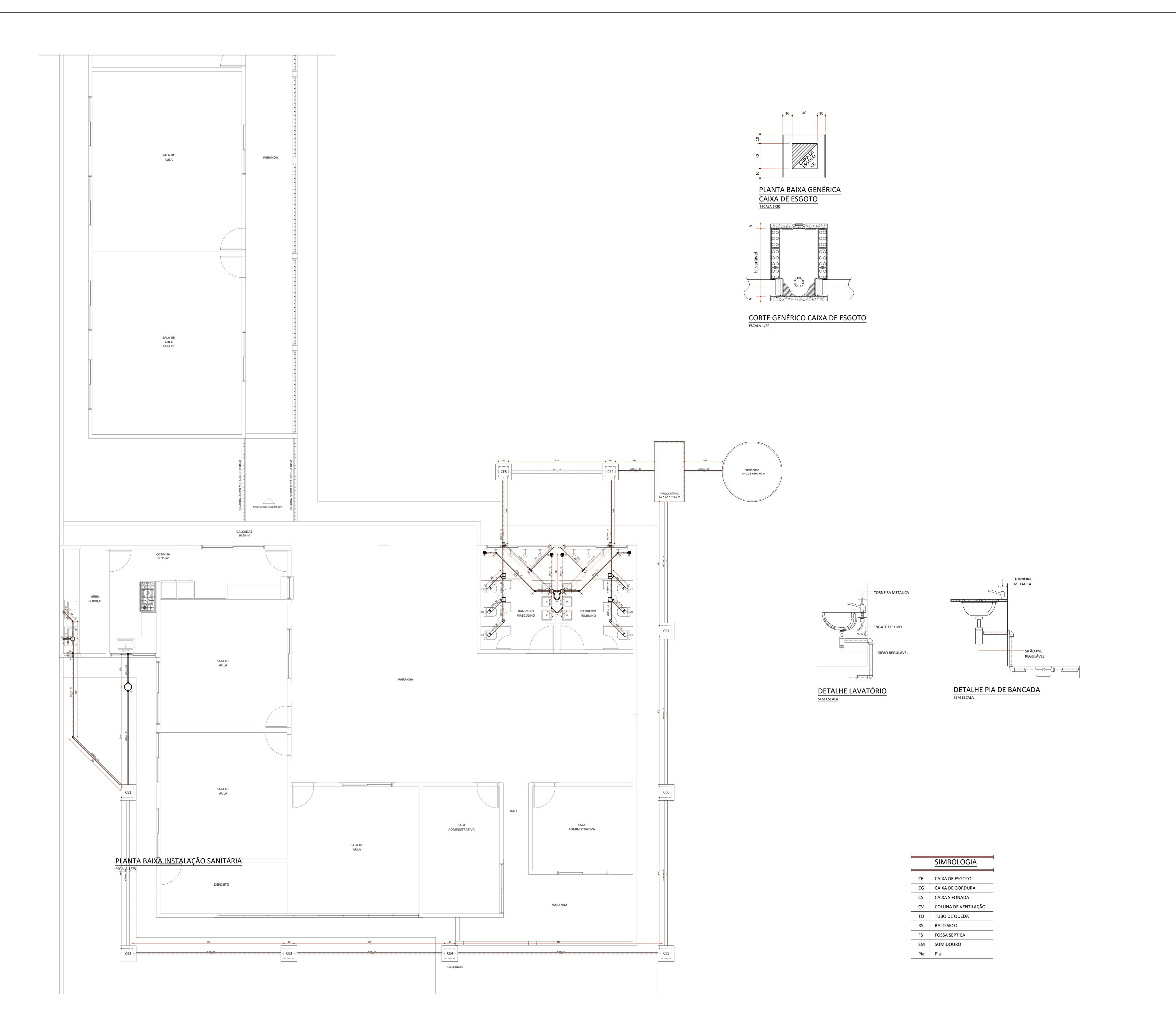
TABELA DE PEÇA HIDROSSANITÁRIA QUANTIDADE DESCRIÇÃO CAIXA SIFONADA, PVC, DN 100 X 100 X 50 MM, JUNTA ELÁSTICA RALO SIFONADO, PVC, DN 100 X 40 MM, JUNTA SOLDÁVEL CAIXA ENTERRADA HIDRÁULICA RETANGULAR, EM ALVENARIA COM BLOCOS DE CONCRETO, DIMENSÕES INTERNAS: 0,6X0,6X0,6 M
