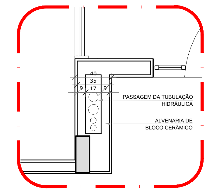
2 DETALHE - SHAFT HIDRÁULICA ESCALA 1/25
